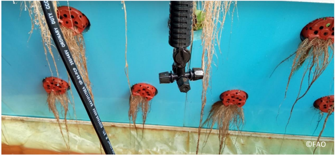
صورة 93: المرشحات الرذاذ رباعية الفتحات مع الثقالة
