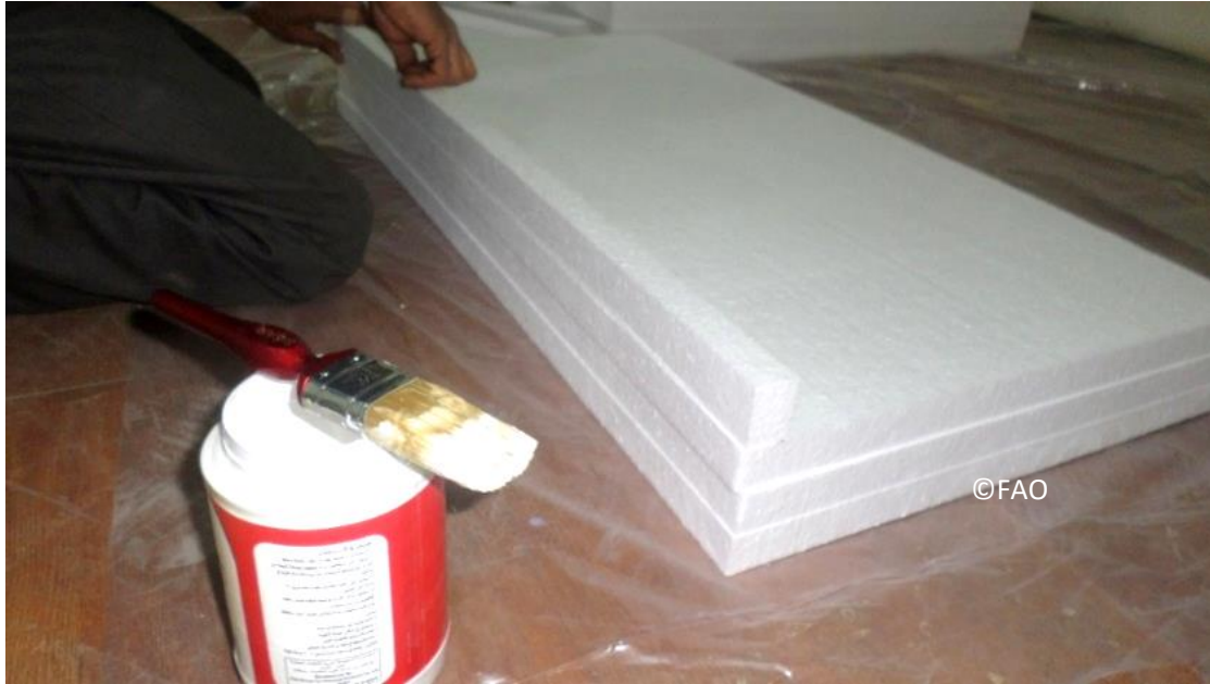
صورة 61 استعمال غراء الخشب للصلق قطع البوليستيرين ببعضها
