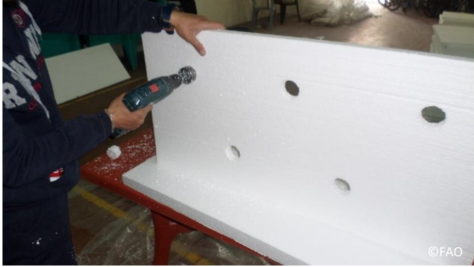
صورة 63: عمل ثقوب دائرية في غطاء القناة لزراعة النباتات
