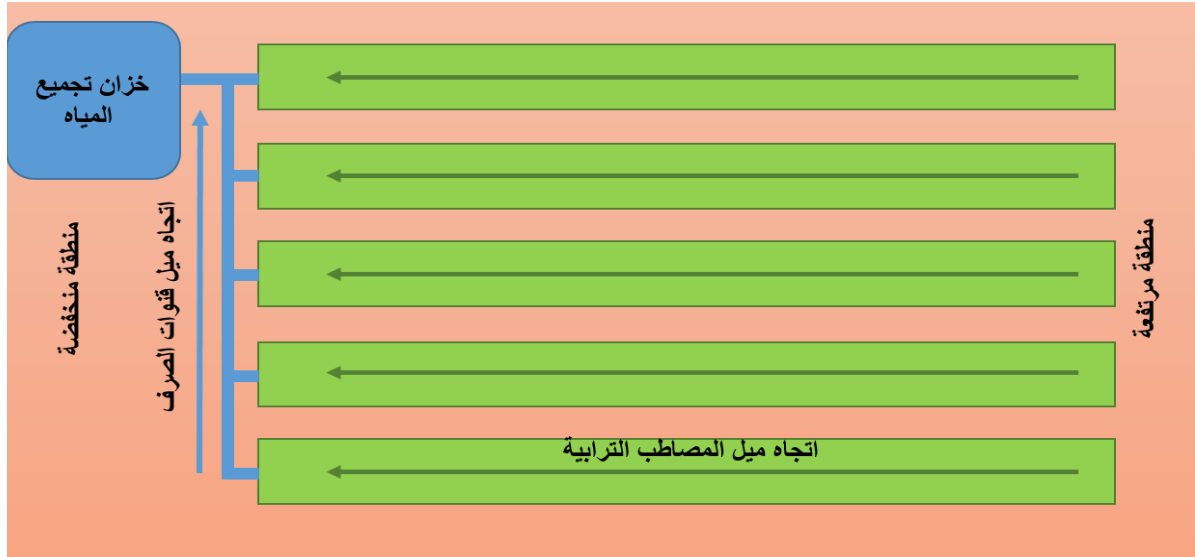
رسم توضيحي 5: تصميم ميلان المصاطب وقنوات الصرف
