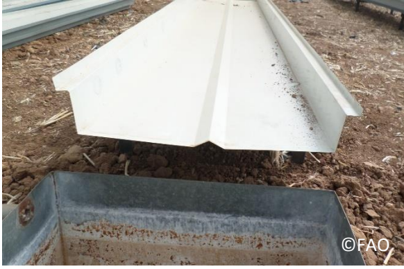
صورة 81: قنوات الزراعة المصنوعة من الحديد المغلفن والمطلي
