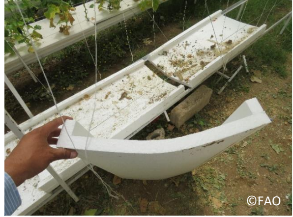
صورة 41: انحناء قنوات الزراعة المصنوعة من البوليستيرين
