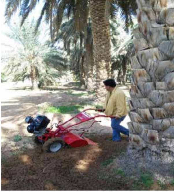
الشكل 23. استخدام العزاقة الآلية لنظافة الحشائش وتقليب التربة في حوض النخلة
