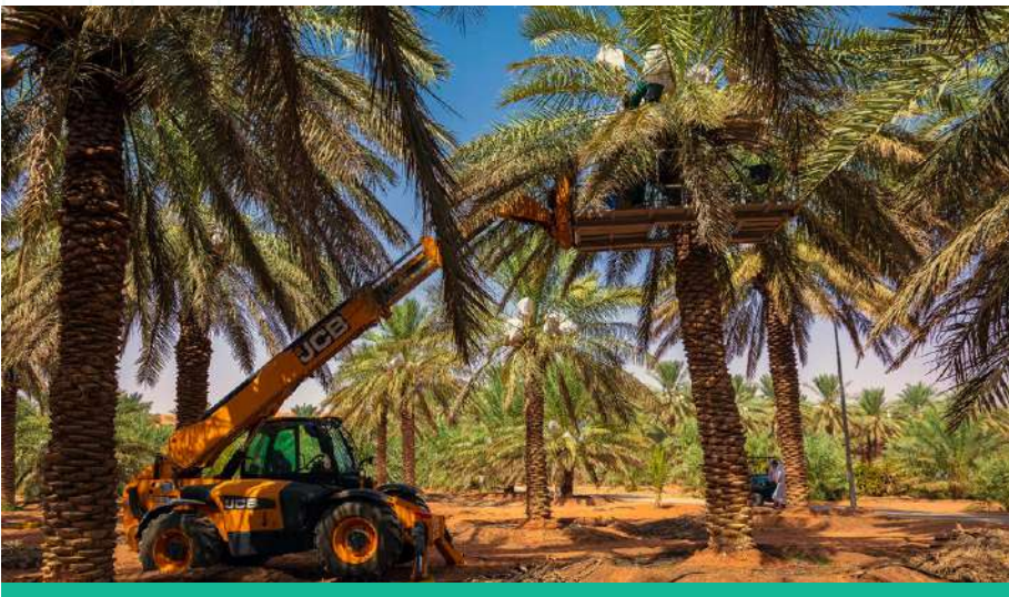
(صورة ١٤٥) رافعة هيدرولوكية لخدمة رأس النخلة ولجني التمور والربطب
