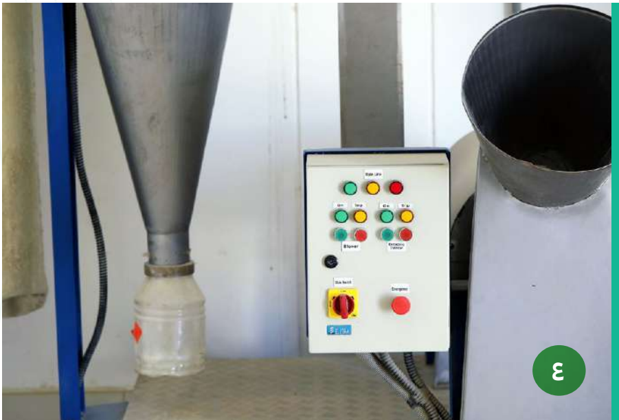
صورة (٤٣) توضيح جهاز استخلاص حبوب اللقاح آلياً باستخدام خاصية الطرد المركزي
