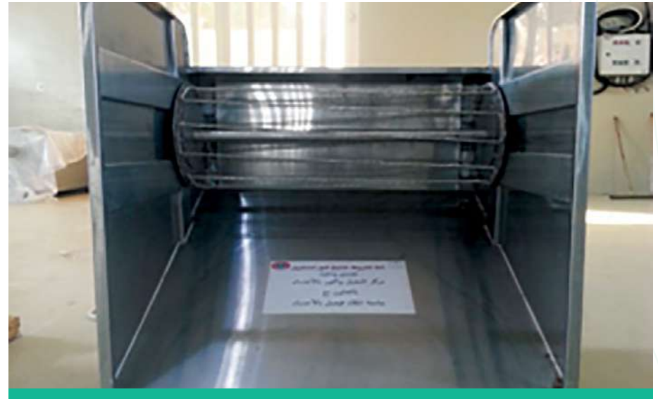
صورة رقم (١٤٩) آلة فصل تمور النخيل من العذوق
