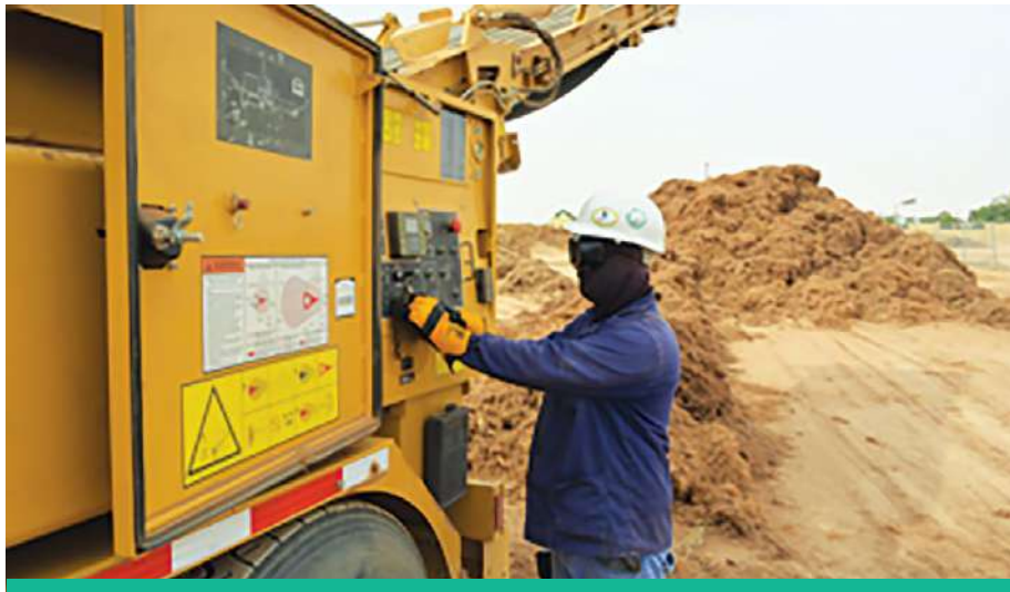
صورة (٩١) معايرة الفرامة لإعادة عملية الفرغ وذلك للتحكم بحجم نواتج الفرغ
