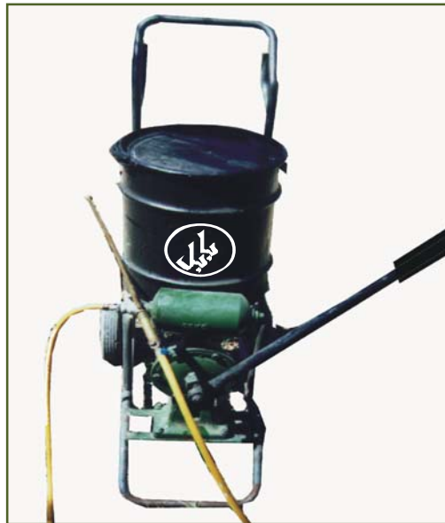
شكل (1): مضخة ماصة كابسة مع خزان سعة 25 لتر صممت لحقن النيماتودا في النخيل
