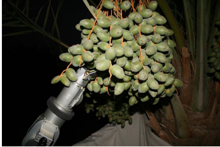
شكل (١٤٧): وصول الذراع الآلي لداخل التمر على النخلة.
