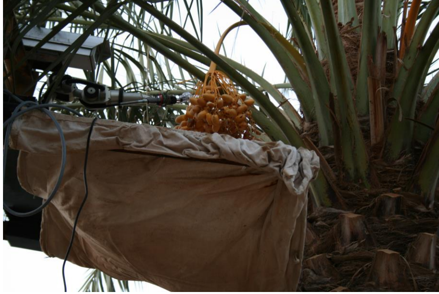
شكل (١٢٤): عمل الذراع الآلي وجهاز القص والكاميرا في الحقل.
