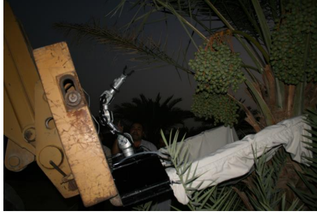
شكل (٩٦): استمرار رفع شوك الرافعة الحاملة للذراع الآلي ناحية النخلة مع التوجيه.
