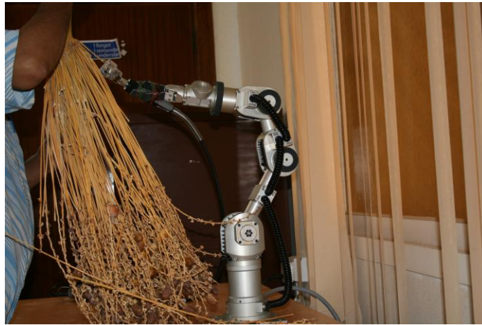
شكل (١١٤): تجربة جهاز القص والذراع الآلي معمليا لقص أفرع التمر.
