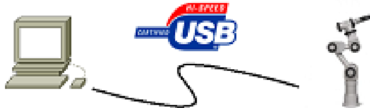
شكل (٨٣): كيفية توصيل الذراع بالحاسب الآلي عن طريق وصلة USB.
