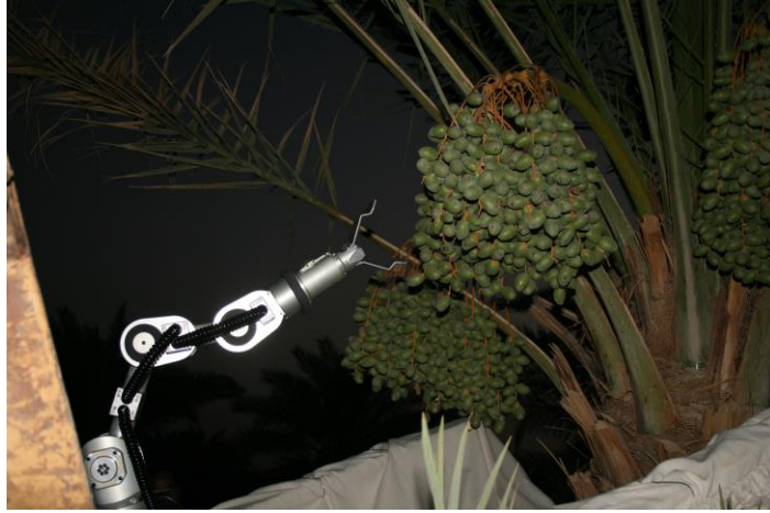
شكل (٩٧): توجيه الذراع الآلي عن طريق الحاسب الآلي إلى الهدف.
