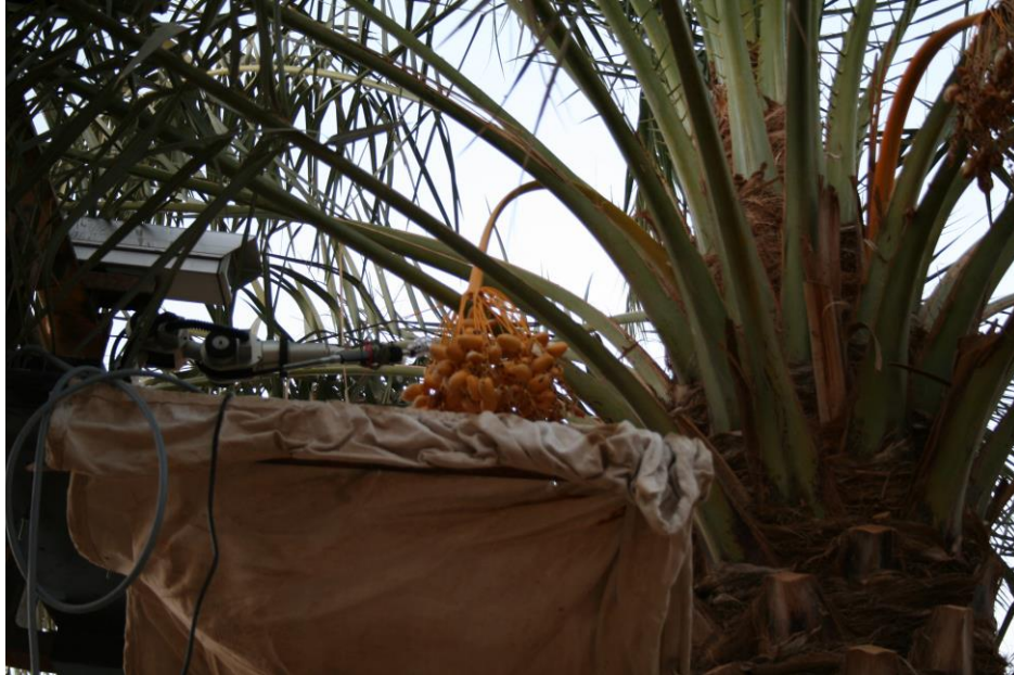
شكل (١٢٥): تغيير حركة عمل الذراع الآلي وجهاز القص والكاميرا في الحقل.
