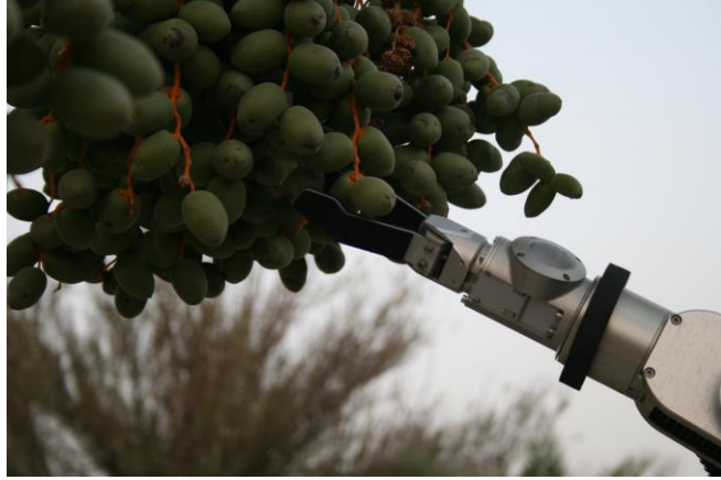
شكل (١٥٠): دخول الذراع الآلي إلى عذق التمر.
