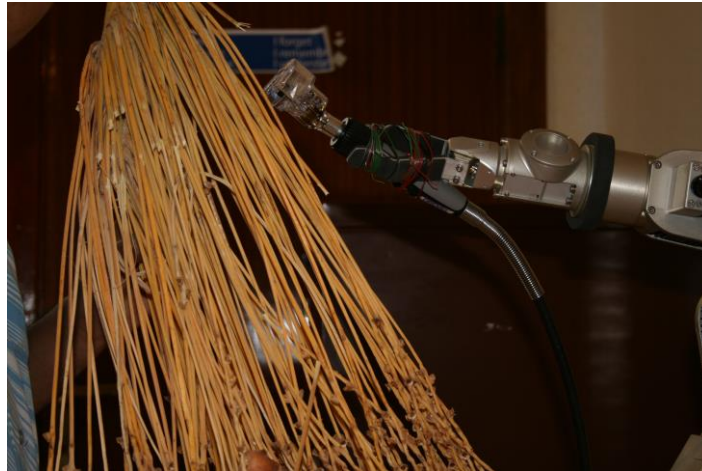
شكل (١٠٧): جهاز القطع على الذراع الآلي وتجربته معمليا لقطع أفرع التمر.
