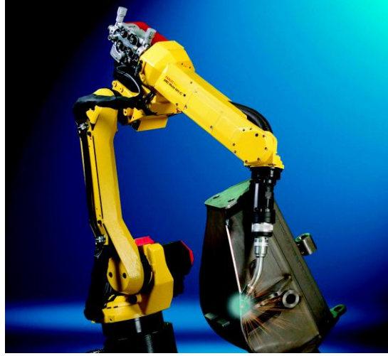
شكل (١٢٨): الربوط الثاني من نوع AM100iC من شركة FANUC يعمل في أغراض مختلفة.
