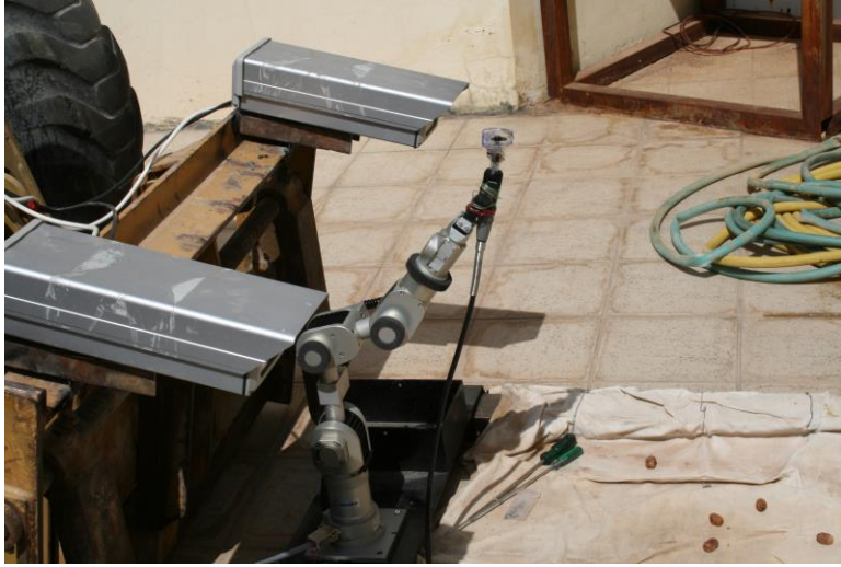
شكل (١١٦): تغيير حركة الذراع الآلي وجهاز القص بعد تثبيتهم على الرافعة.
