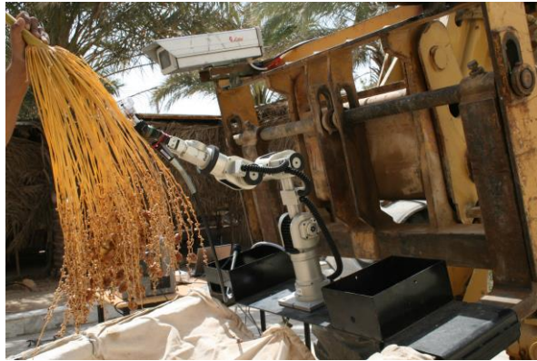
شكل (١١٧): تجربة ومحاكاة وصول الذراع الآلي وجهاز القص بعد تثبيتهم على الرافعة لعذق التمر.
