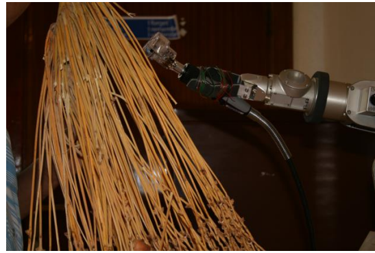
شكل (١١٣): تثبيت جهاز القص على الذراع الآلي بطريقة يدوية وتجربته معمليا لقص أفرع التمر.
