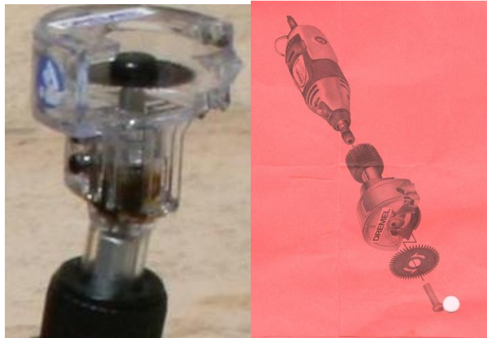
شكل (١٠٤): وضع الطارة المسننة لعملية القطع.
