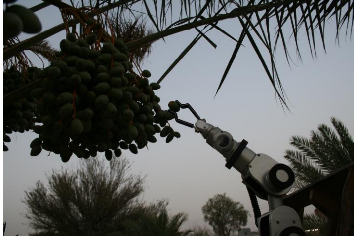
شكل (١٥٣): الذراع الآلي قام بعملية التواء لقص التمرة.
