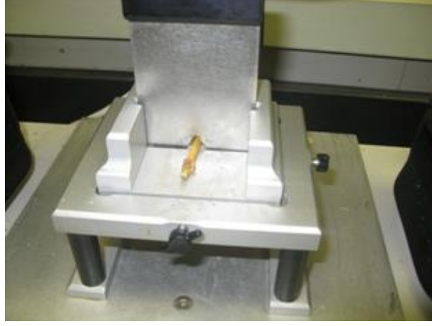
شكل (١٠١): قياس القوة اللازمة لقص الأفرع الحاملة للتمور معمليا .
