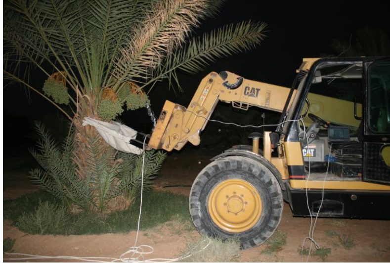
شكل (١٠٠): المنظومة متكاملة (الرافعة، الذراع، الحاسب الآلي) أثناء العمل الحقلي.
