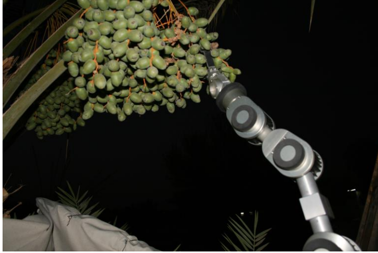
شكل (٩٩): إجراء التواء للذراع (الجزء الأخير) لقص التمور وإسقاطها على الجزء القماش المعد لذلك.
