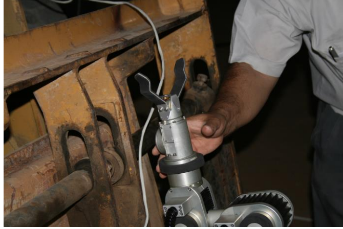
شكل (٩٣): عمل المعايرة للذراع الآلي للتأكد من التشغيل.
