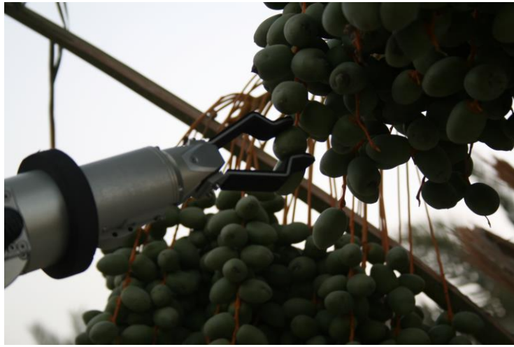
شكل (١٥١): محاولة مسك ثمرة واحدة بواسطة الذراع الآلي.
