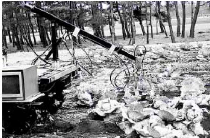
شكل (٣٤): حصاد الكرنب في الحقل باستخدام ربوط Murakami وآخرون (بدون تاريخ).
