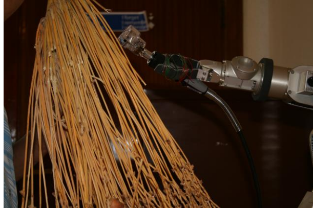
شكل (١٠٩): أفرع التمر بعد قطعها بجهاز القطع على الذراع الآلي أثناء تجربته معمليا.
