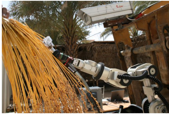
شكل (١١٩): تغيير محاكاة حركة وصول الذراع الآلي وجهاز القص لإجراء عملية قص عذق التمر.
