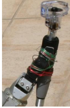
شكل (١٠٥): يمكن ربط جهاز القطع مع الذراع الآلي.
