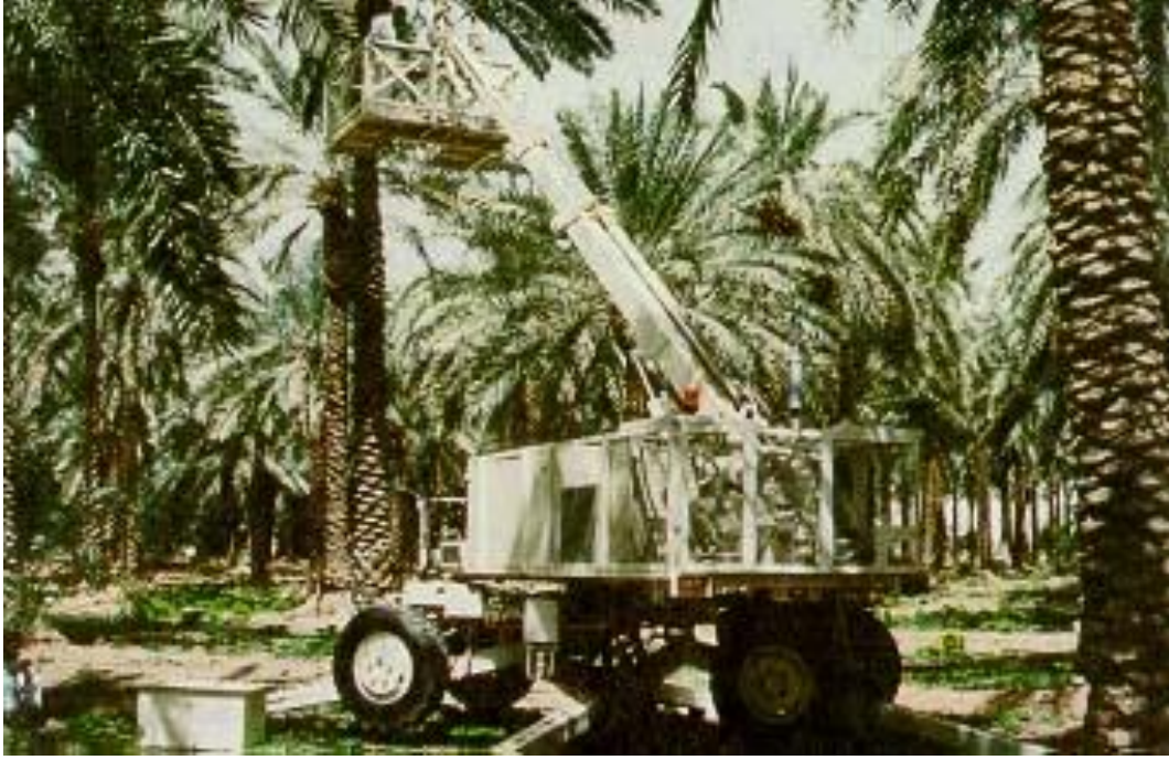
شكل (٦): آلة خدمة النخيل أثناء عملها بالحقل Al-Suhaibani (١٩٨٨م).
