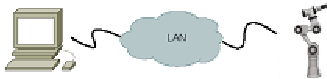
شكل (٨٢): كيفية توصيل الذراع بالحاسب الآلي عن طريق كبل شبكة.
