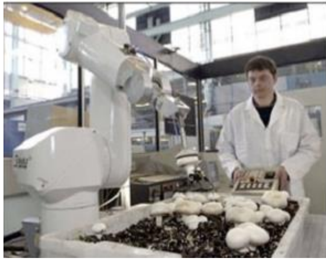
شكل (٣٣): استخدام الذراع الآلية في حصاد عيش الغراب Reynolds (بدون تاريخ).
