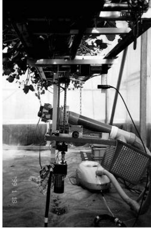
شكل (٤١) : استخدام الروبوت في حصاد الفراولة المزروعة في مصاطب Kondo وآخرون (٢٠٠٥م).
