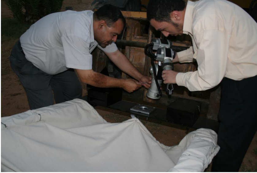
شكل (٩١): صورة المنصة عليها الذراع الآلي الأولى مركبة على شوكة الرافعة.
