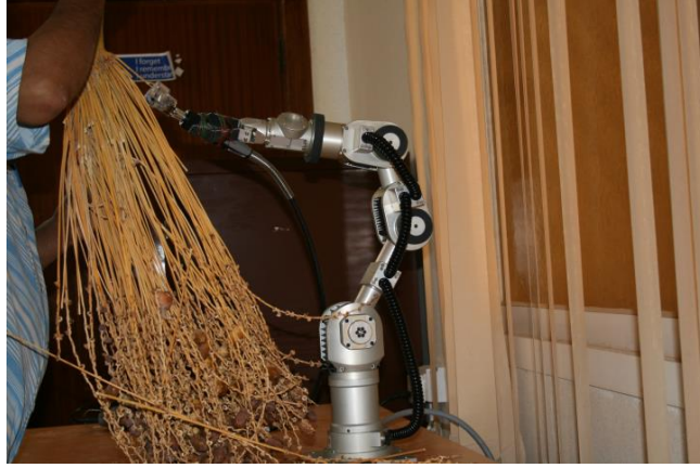
شكل (١٠٨): يمكن التحكم في جهاز القطع على الذراع الآلي أثناء تجربته معمليا قطع أفرع التمر.
