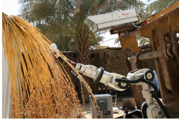
شكل (١١٨): تغيير محاكاة حركة وصول الذراع الآلي وجهاز القص بعد تثبيتهم على الرافعة لعذق التمر.
