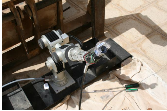
شكل (١١٥): تحريك الذراع الآلي وجهاز القص بعد تثبيتهم على الرافعة.
