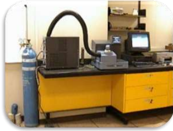
شكل ٣ - ٢٦. جهاز المسعر الحراري التفاضلي لقياس الحرارة النوعية والسلوك الحراري.
