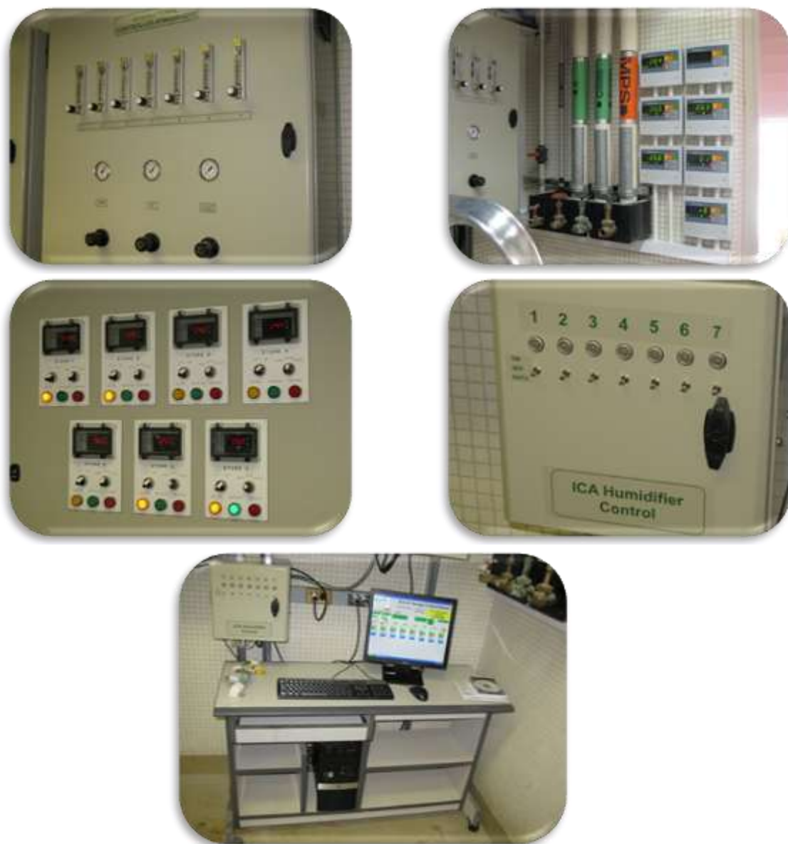
شكل ٣ - ١٤. وحدات التحكم بالغازات المرتبطة بالحاسب الآلي.
