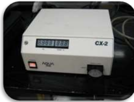
شكل ٣ - ٢١. جهاز Aqualab لقياس النشاط المائي.
