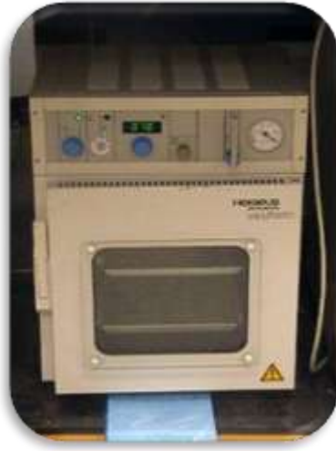
شكل ٣ - ٢٢. فرن التجفيف (تحت تفريغ) لقياس المحتوى الرطوبي.
