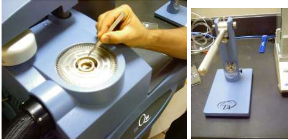
شكل ٣ - ٢٧. جهاز كبس وقفل حاويات العينات (يمين) ومن ثم وضع الحاويات المكبوسة في جهاز التلقيح للمسعر التفاضلي الحراري المعدل (MDSC) لقياس الخواص الحرارية.
