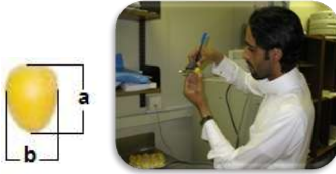
شكل ٣- ١٩. قياس الابعاد باستخدام مقياس رقمي للأبعاد الدقيقة.
