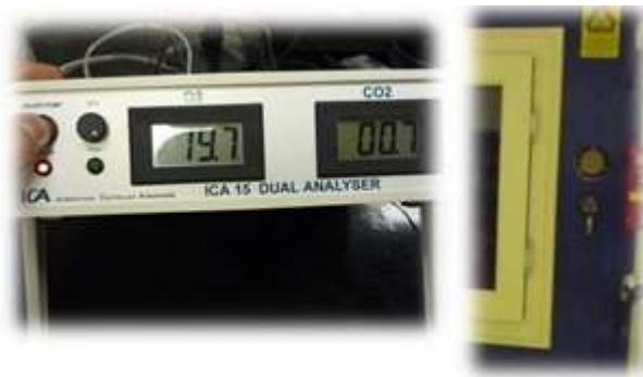
شكل ٤ - ١. الجهاز الخارجي لقياس نسب الغازات من خلال فتحة التصريف على باب الغرفة.
