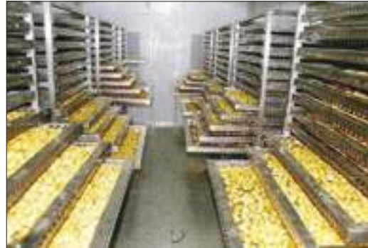
جهاز تجفيف التمور سعة 3000 كغ
