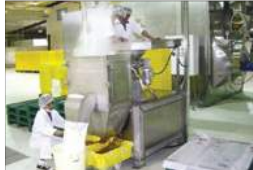
ماكينة إنتاج عجينة التمور بطاقة 300 كغ بالساعة
