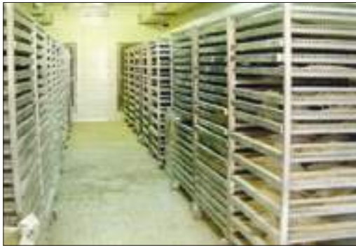
جهاز تجفيف حبوب اللقاح الحديثة (التصميم الجديد) من الداخل تبين طريقة وضع الطلع الذكري داخل العربات
