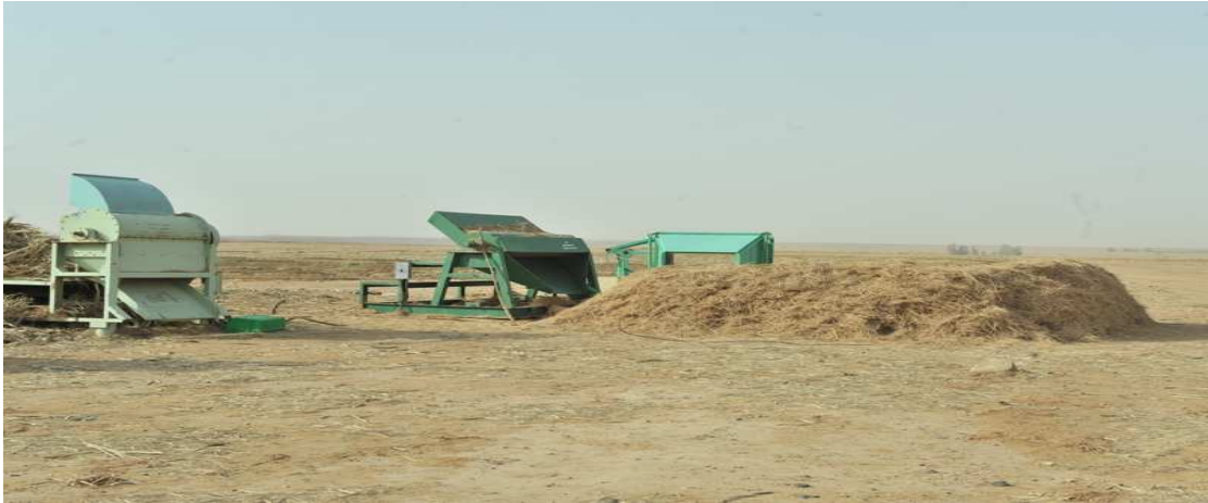
صورة (١٨): مكائن فرم نواتج تقليم النخيل لإعداد السماد العضوي(كمبوست)هوائي- مشروع الباطن - القصيم.
