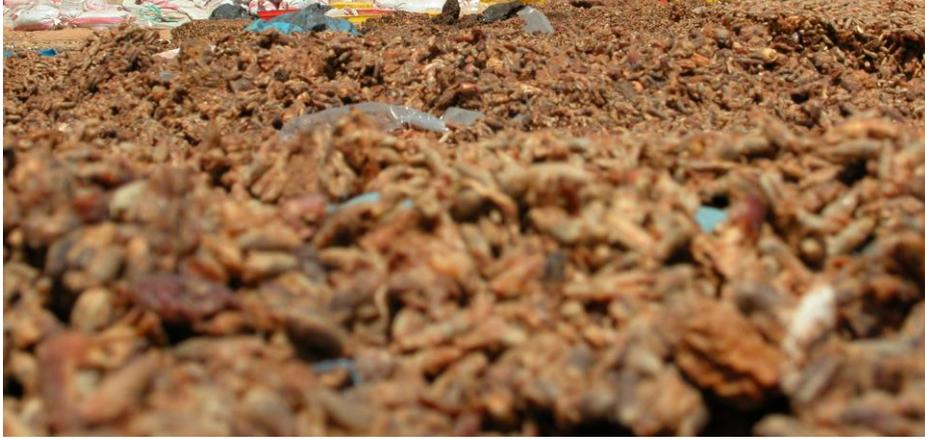
شكل (٨). أكوام هائلة من النوى مرمية كمخلفات لصناعة عجائن التمور مسببة خسارة للمصنع في عدم الاستفادة منها وتلوث بيئي بالإمكان الاستفادة منها في صناعة الكربون النشط.
