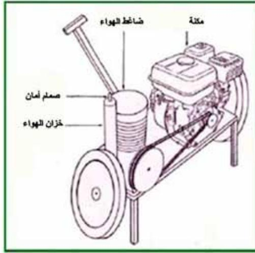
الشكل 5. المكنة وضغط الهواء.
