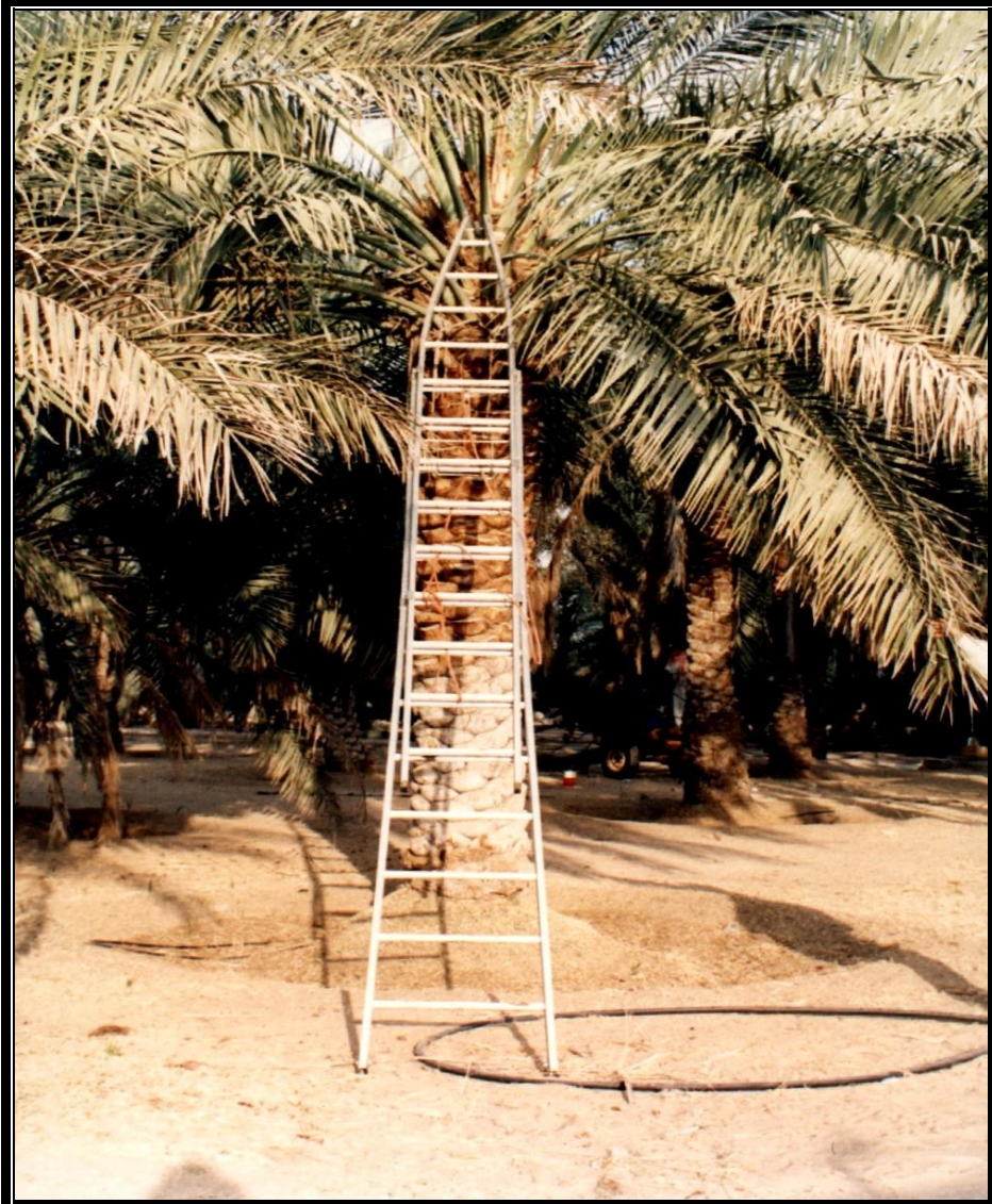
شكل رقم (42): السلالم الألمنيومية ذات النهاية الحادة والمستخدم للوصول إلى رأس النخلة
