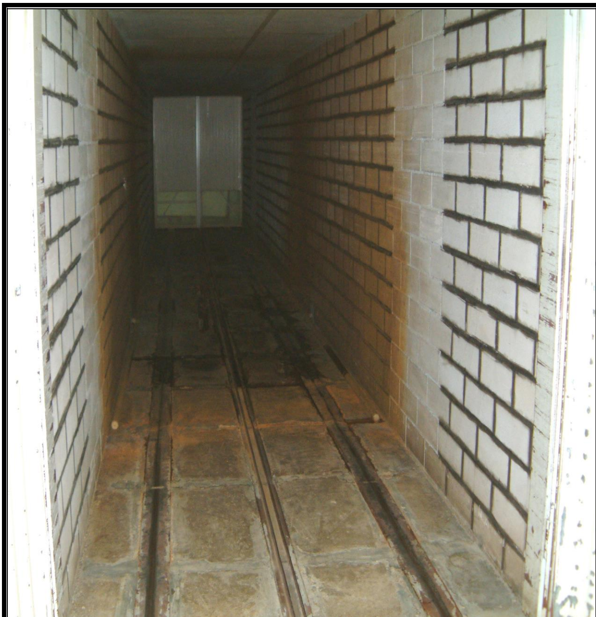
شكل رقم (54): غرفة ترطيب وتجفيف التمور (غرفة معالجة التمور)
