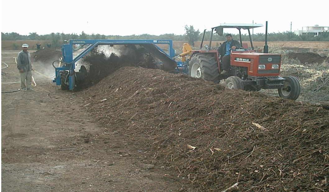
شكل رقم (7) آلة تقليب الكمبوست
