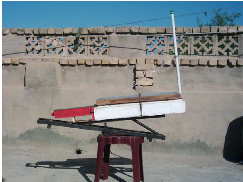
شكل (2): صورة فوتوغرافية للمجفف الشمسي الشبه مختلط
