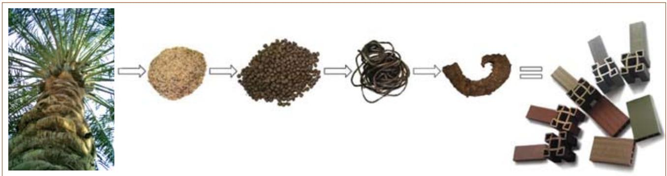
صاحب الملكية الفكرية وذلك بتصنيع وحدات إنتاجية تشتمل على عمليات البثق Extrusion أو عمليات الحقن القولي Injection Mol -ing أو عمليات الخلط الحراري Thermal Mixer أو عمليات الترقيق الحراري Cylindri-cal Process أو عمليات الخلط الحراري Mixer أو عمليات الترقيق الحراري Cylindri-cal Process من مخلفات النخيل والبوليمرات البلاستيكية ونذكر أدناه قسماً من تلك البوليمرات وكما يلي:
