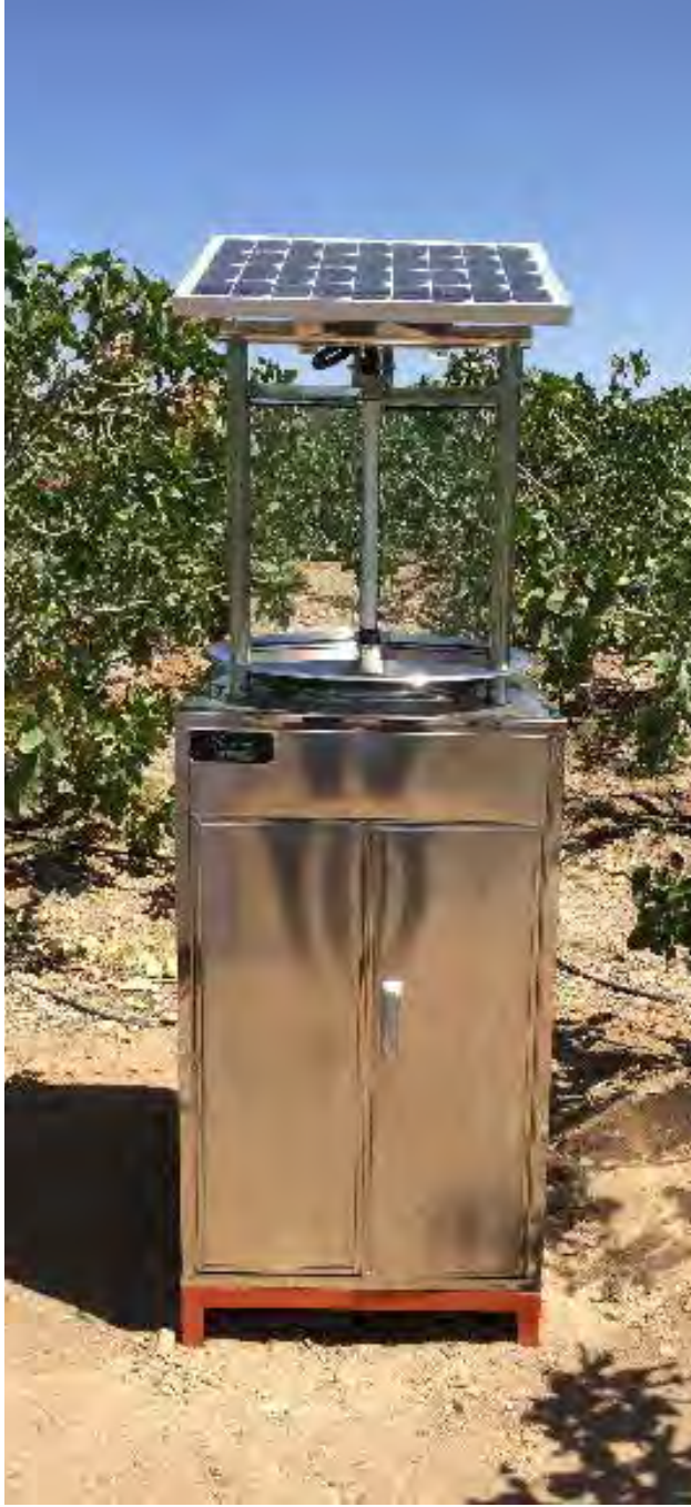
شكل (33): مصيدة ضوئية تعمل بالطاقة الشمسية.
